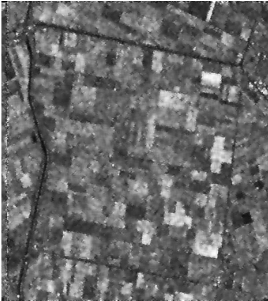
FIG. 2.13 – Résultat de la restauration par le filtrage de Lee de l'image radar présenté en figure 2.10.
